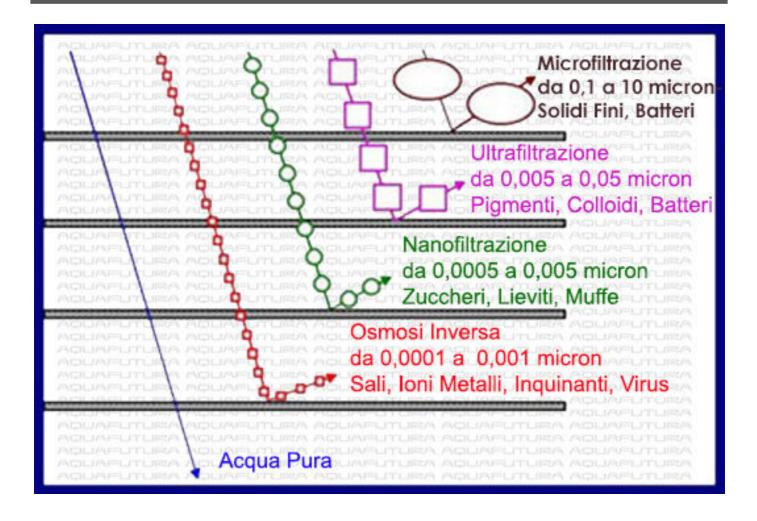
In un quadro ideale che riassume particelle e molecole che si desideri eliminare dall'acqua o altri fluidi, la Micro-filtrazione (MF) comprende quelle di dimensione superiore al micron (quindi > 1.000.000 di millimetro).
