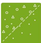
Diametro nominale dei pori **0,03 micron\*** per la rimozione di batteri, virus e particelle compresi i colloidi. Ideale per proteggere a valle processi come la Osmosi Inversa.
